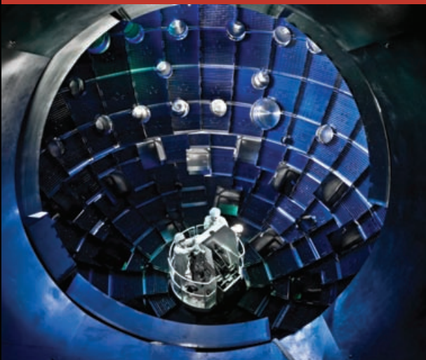
Cámara donde se colocan los objetivos a los que apunta el láser. CRÉDITOS: NIF
