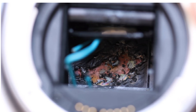
Fig 18. Cámara con su sensor destruido luego de algunos experimentos fotográficos durante un eclipse solar. Créditos: DIY Photography.
