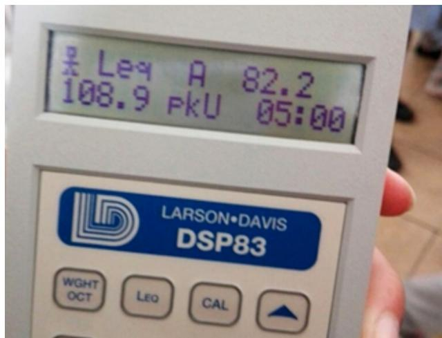
Figura N°2. Sonómetro Calibrado utilizado en las mediciones.
